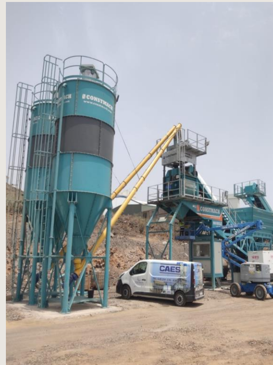
Planta de Hormigón móvil con Mezcladora CONSTMACH
