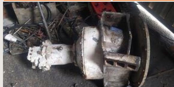
Reductora de hormigonera rota
