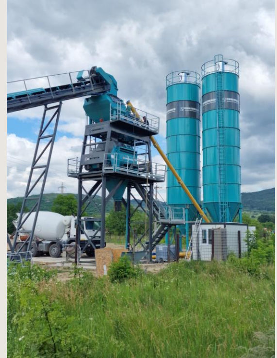
Planta de Hormigón fija con Mezcladora CONSTMACH
