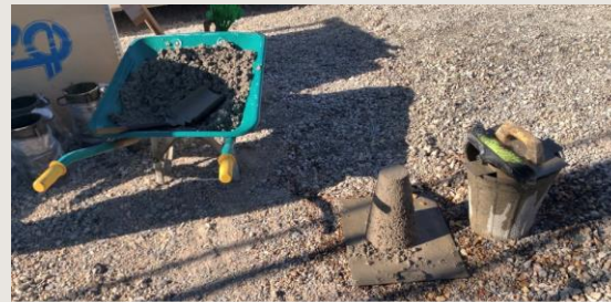
Ensayo del cono de Abrams
