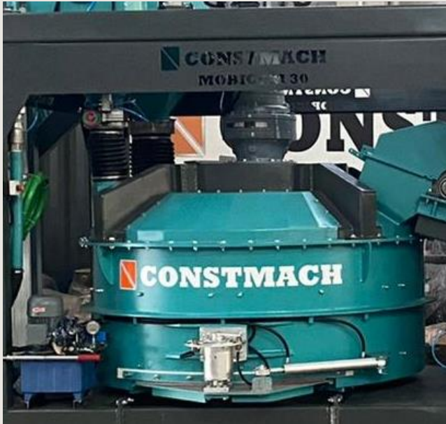
Mezcladora planetaria CONSTMACH
