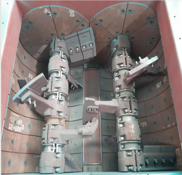
Mezcladora de doble eje horizontal CONSTMACH
