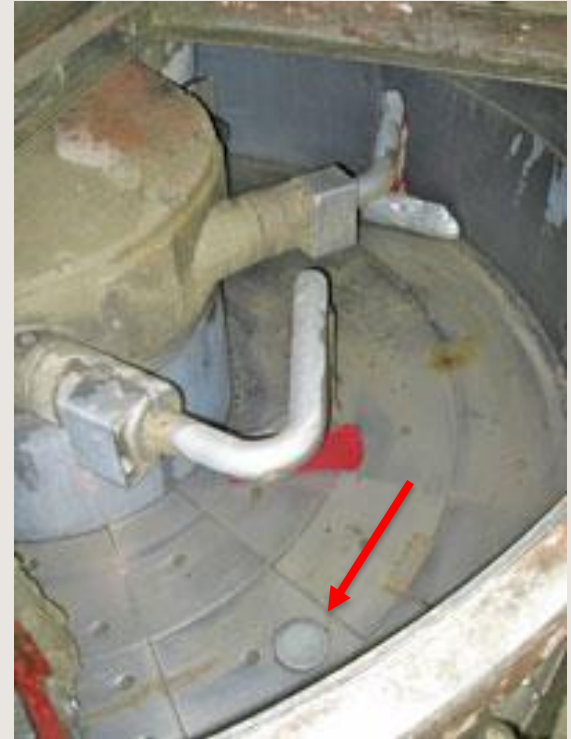
Sensor de Humedad dentro de Mezcladora CONSTMACH
