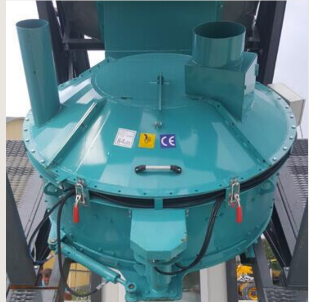
Mezcladora de eje vertical CONSTMACH
