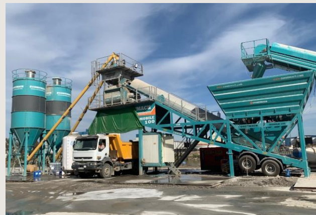
Planta de Hormigón móvil con Mezcladora CONSTMACH fabricando Grava-Cemento y dosificando sobre camión bañera o volquete
