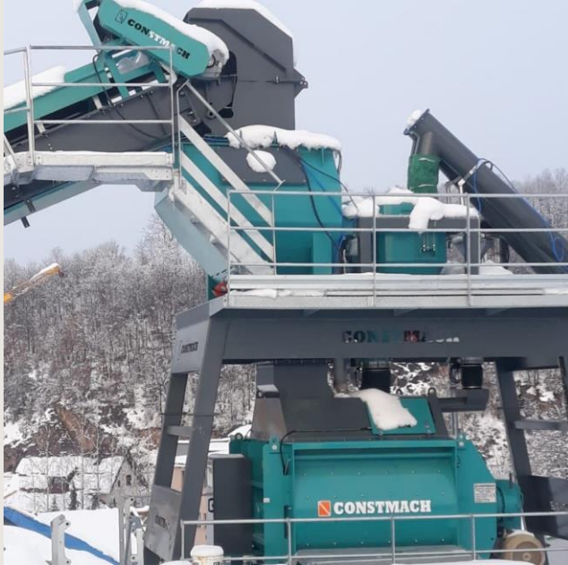
Básculas de pesaje y tolva de espera en planta de hormigón con mezcladora CONSTMACH
