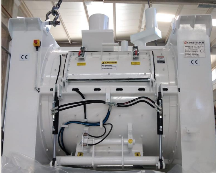
Mezcladora de simple eje horizontal CONSTMACH
