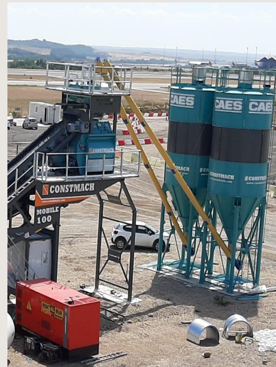
Planta de Hormigón móvil con Mezcladora CONSTMACH
