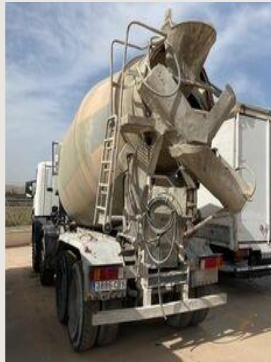
Camión hormigonera sucio por desbordamientos en planta
