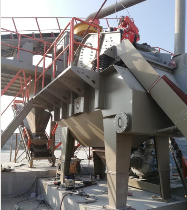
Hidrociclón y Escurridor de CAES-CONSTMACH
