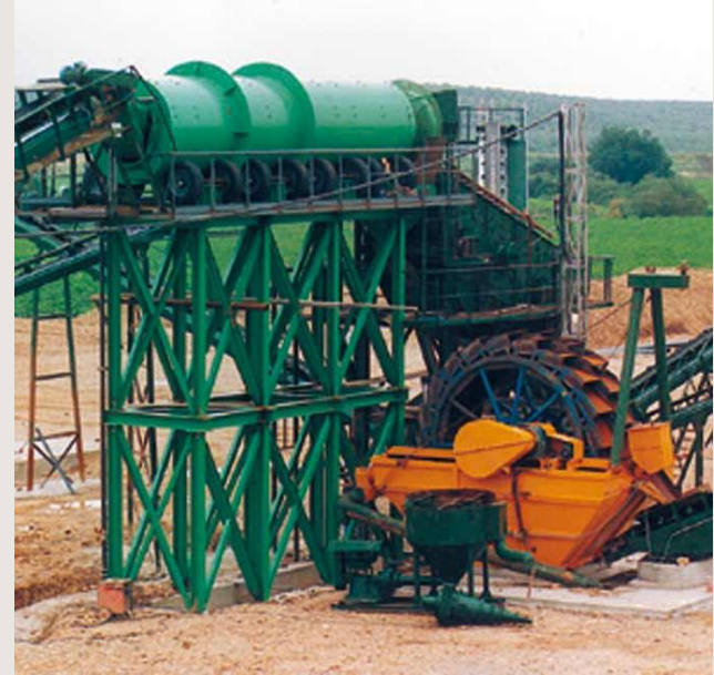
Tromel lavador en planta CAES-CONSTMACH
