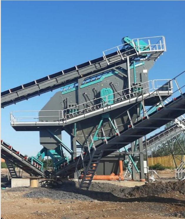
Criba vibrante con lavado CAES-CONSTMACH
