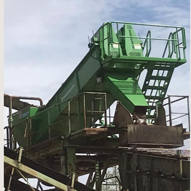
Tornillo lavador doble CAES-CONSTMACH
